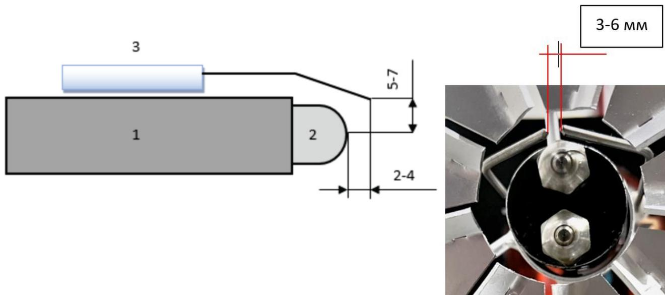
1 - инжектор горелки; 2 – форсунки; 3 - электрод
