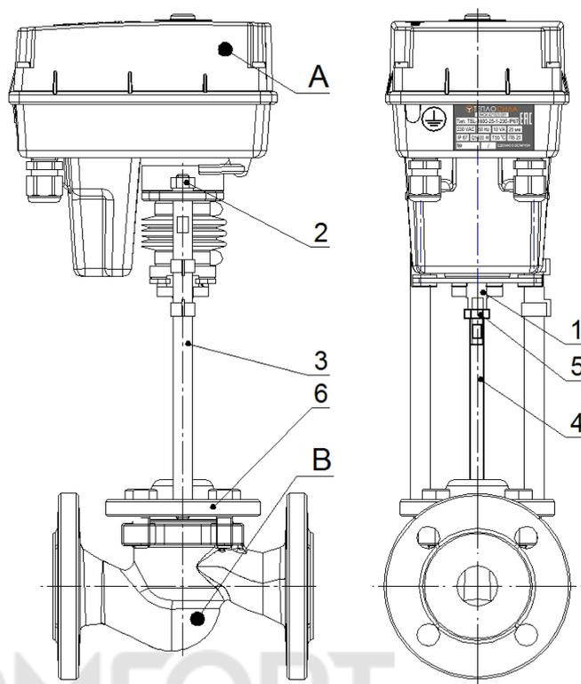
Рисунок 2 – Монтаж электропривода в столбчатом исполнении
