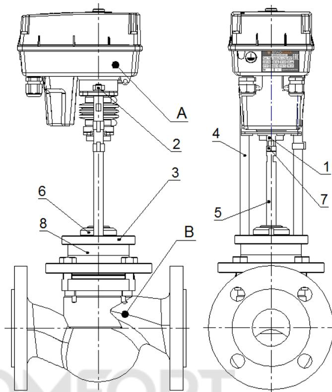
Рисунок 3 – Монтаж электропривода во фланцевом исполнении
