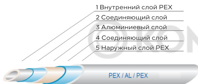
Трубы GAPPO «Стабил» состоят из основного слоя сшитого полиэтилена РЕХ-а натурального цвета (прозрачный) и антидиффузионного слоя алюминия и наружного слоя сшитого полиэтилена РЕХ-а белого цвета. Между слоев располагается соединяющий полимерный слой.
