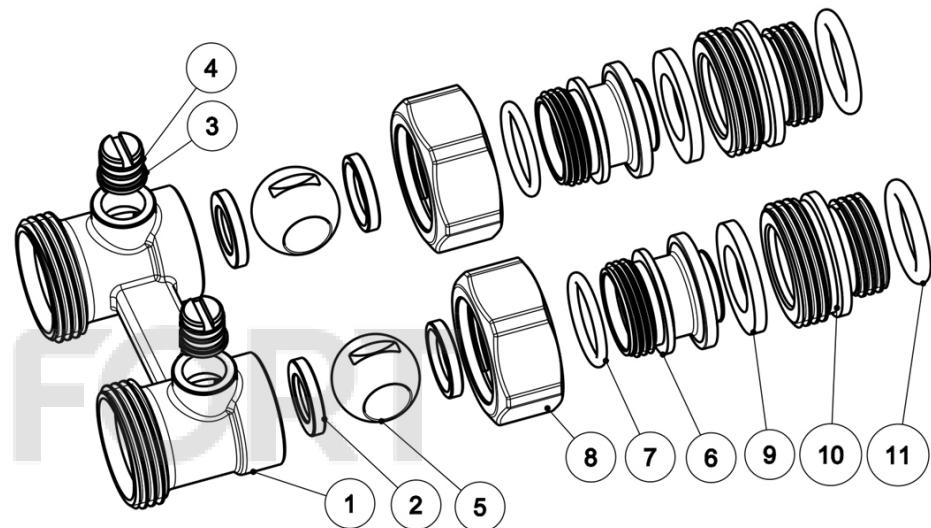
В корпусе ① вставлены запорные шары ⑤ с уплотнителями ②. Присоединение к прибору с выходами G3/4 осуществляется посредством накидной гайки ⑧, фиксируемой защитным наконечником ⑥. Если выходы отопительного прибора выполнены с внутренней резьбой G1/2, то для присоединения узла нижнего подключения применяется переходной ниппель ⑩, оснащенный уплотнительным кольцом ⑪.
