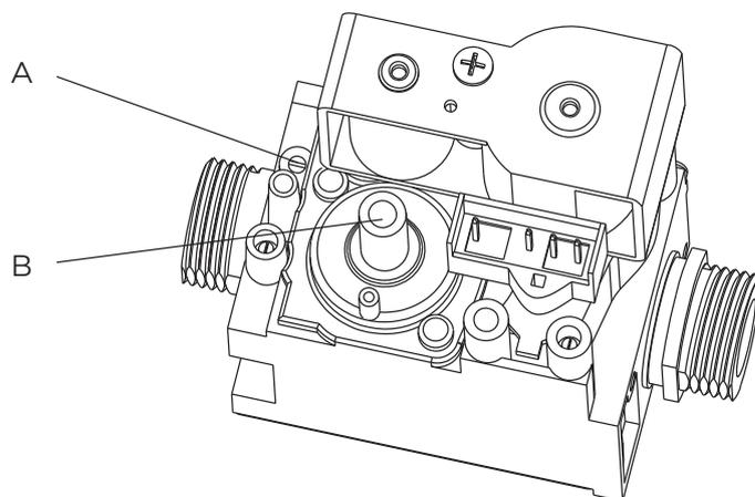
Рис. 35. Газовый клапан. А: ручка регулировки отношения компонентов газовой смеси – регулировка при максимальной мощности.
