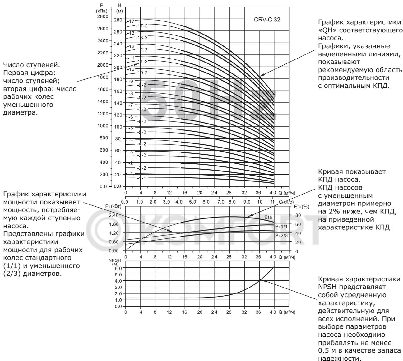
**Рис. 11** Расположение данных на диаграммах рабочих характеристик
