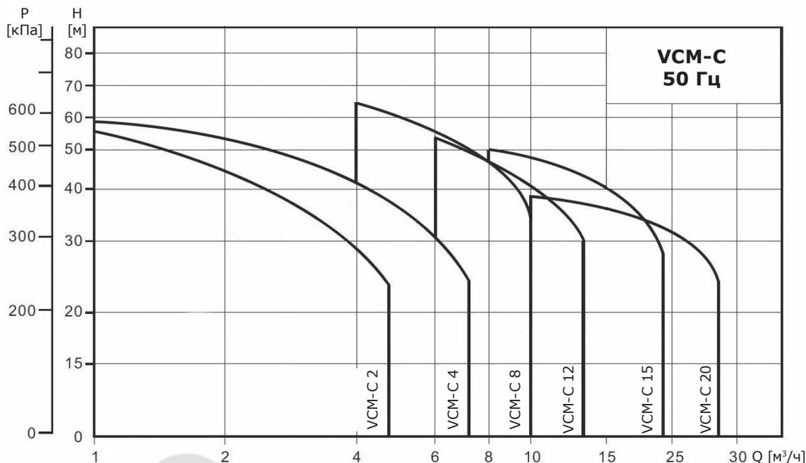
Рис. 14 Диапазон характеристик насосов VCM-C-C 50 Гц
