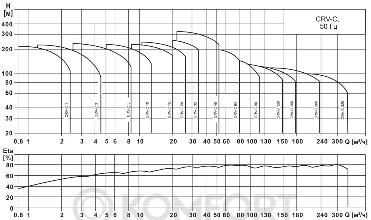
Рис. 2 Диапазон характеристик насосов серии CRV-C, 50 Гц
