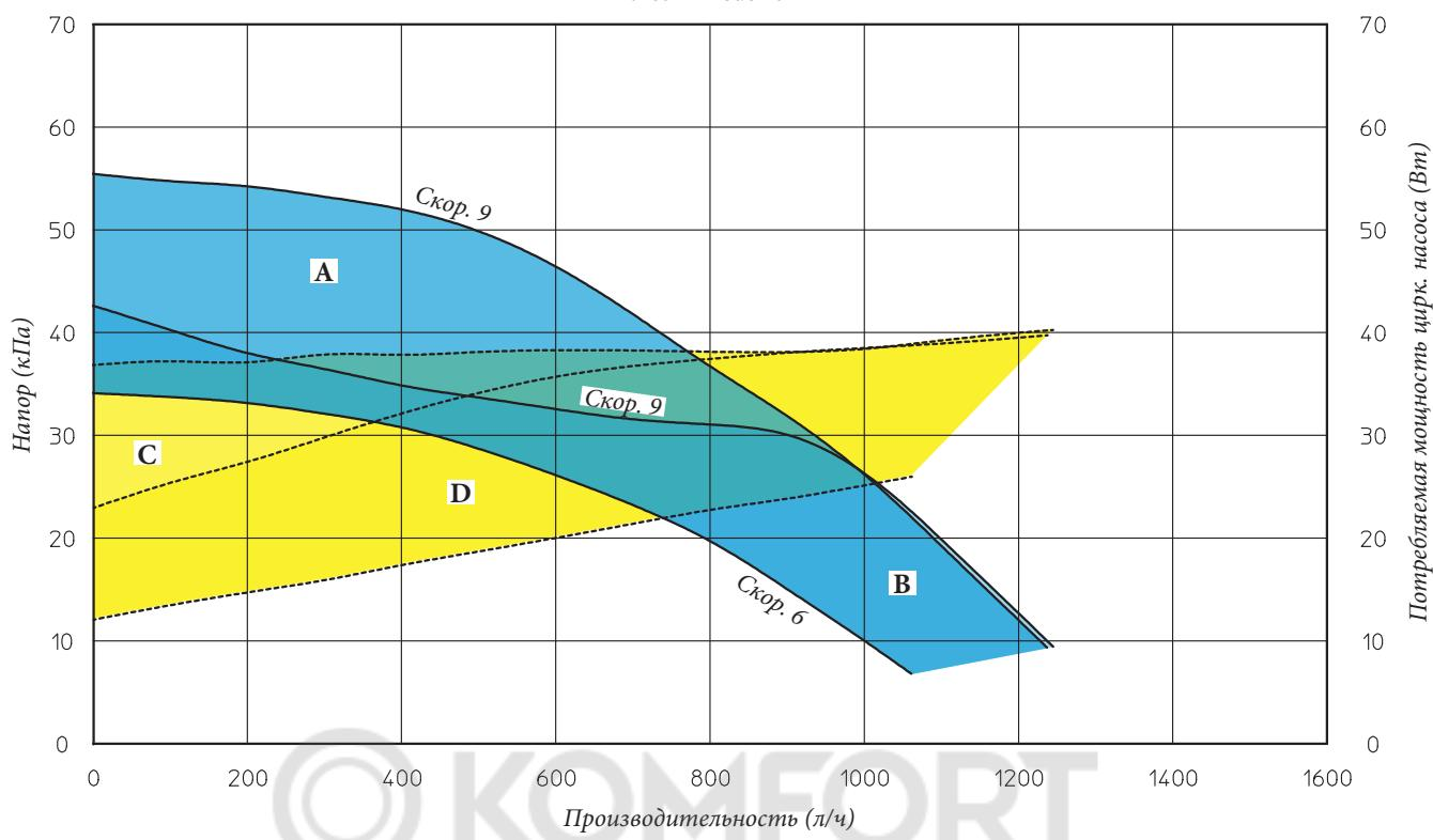
A+B = Напор, достигаемый в системе при закрытом байпасе
