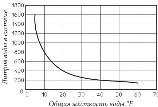
**Примечание:** График описывает полный срок эксплуатации установки. Следует учитывать также плановое и эксплуатационное техобслуживание, при которых выполняется слив и заполнение установки.
