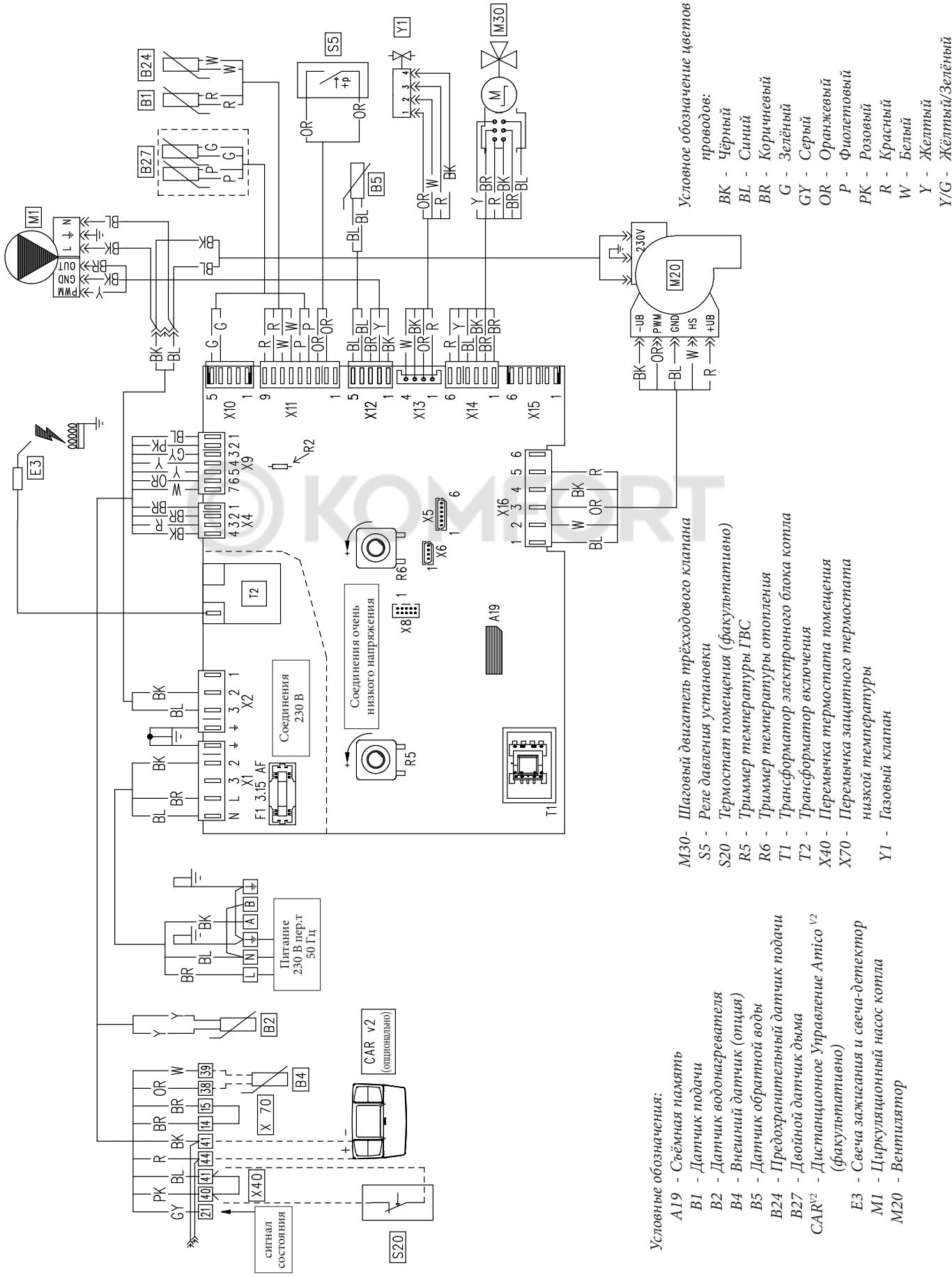
Пульт дистанционного управления или комнатный термостат Вкл/Выкл подключается к клеммам 40 и 41, удалив перемычку X40.
